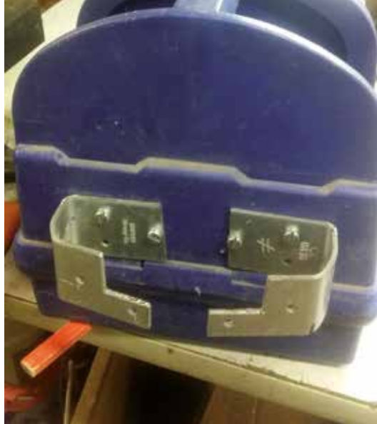
Figur 2 + 3. Et vinkeljern er skåret til som røgpusterholder og er boltet fast til værktøjskassen. Her kan en varm røgpuster fint sidde uden at forvolde skade.
