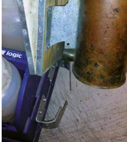
Figur 2 + 3. Et vinkeljern er skåret til som røgpusterholder og er boltet fast til værktøjskassen. Her kan en varm røgpuster fint sidde uden at forvolde skade.
