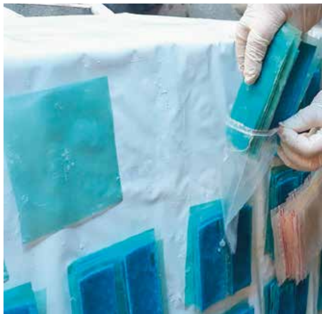
Figur 5. Strimlerne pakkes i plastikposer og opbevares køligt til de skal bruges. Mellem hver strimmel lægges et lag plastik.
