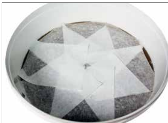
Figur 37. Dæk overfladen med madpapir (eller bagepapir (det passer i bredden til en stor tappespand); husholdningsfilm kan også bruges) og lad det ligge et øjeblik. Urenhederne vil hæfte til papiret, som herefter forsigtigt kan fjernes. Det kan være nødvendigt at gentage processen. Foto Leif Johansen.
