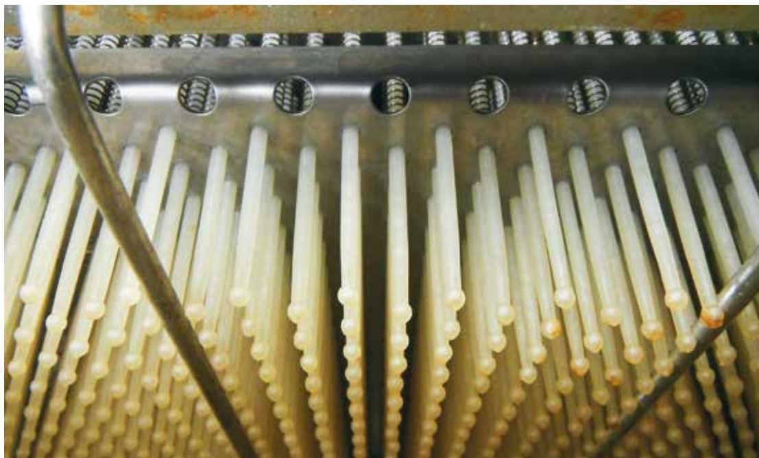
Figur 62. Honningløsnernes nåle skal ind i hver celle op til flere gange inden lynghonningens geléagtige konsistens ændres til flydende. Foto Erling Atzen.
