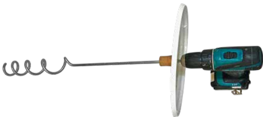
Figur 70. Vores antistøvsskjold bestående af en røresnegl, en prop og et spandlåg med hul i. Foto Lars Fischer og Zofuz Knudsen.
