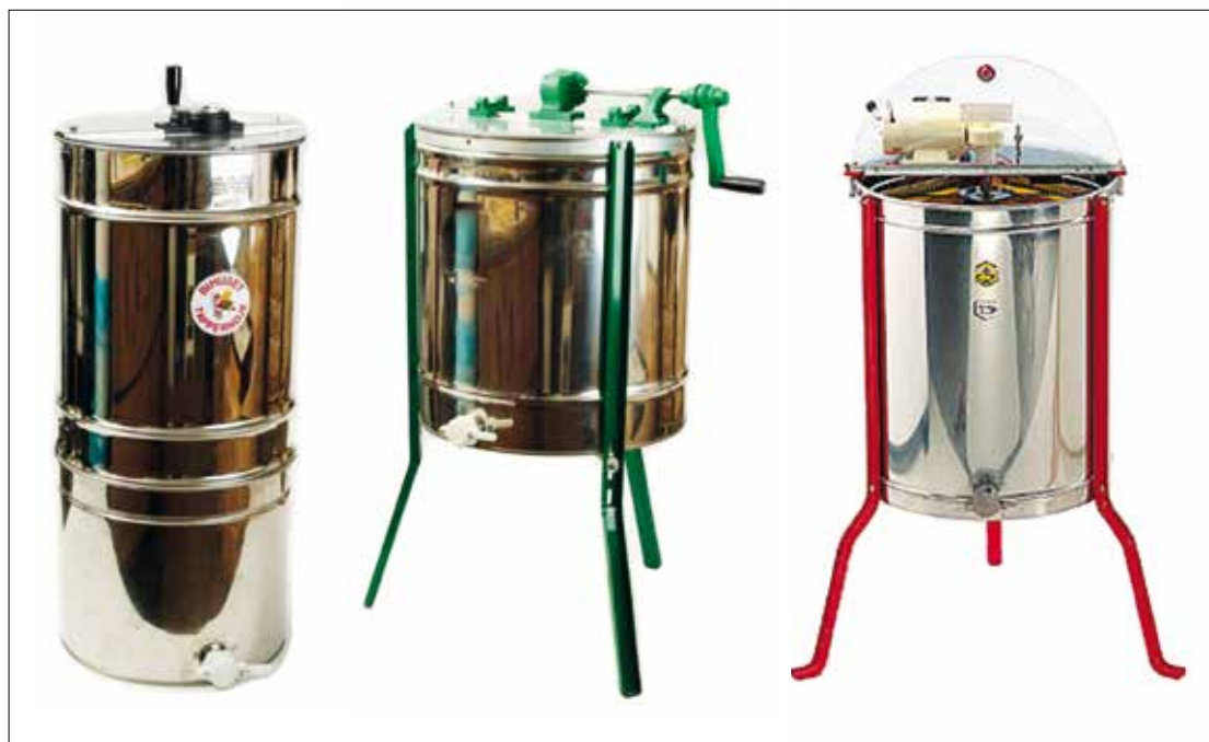
Figur 18. Et lille udvalg af mindre slynger. Tv. en kombi-slynge med indbygget si og tapperspand. I midten slynge med håndsving og t.h. en 4-solds motorslynge.
