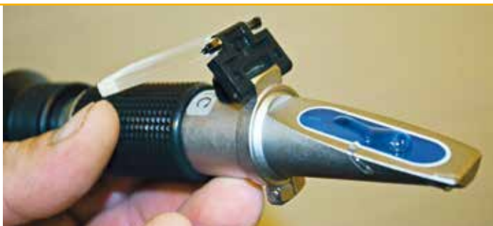
Figur 40. Når honningens vandindhold skal bestemmes, kommer et par dråber honning på glaspladen, som herefter lukkes. Refraktometeret holdes op mod lyset, og vandindholdet kan nu aflæses. Foto Erling Atzen.
