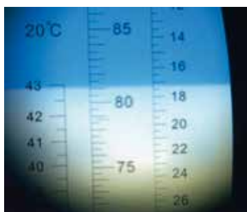
Figur 41. I refraktometeret ses en skala, hvor den øverste del er blå og den nederste del hvid. I skillelinjen mellem blå og hvid kan vandprocenten nu aflæses i den højre. I dette tilfælde er vandprocenten 17,4. Den midterste skala angiver sukkerprocenten (i dette tilfælde 81 %). Foto Erling Atzen.
