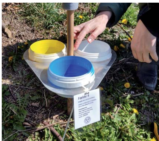
Figur 2 (til venstre). Hver fælde bestod af en gul, en blå og en hvid plasticskål fyldt med 3-400 ml vand tilsat rodalon. Foto: Lise Hansted.
